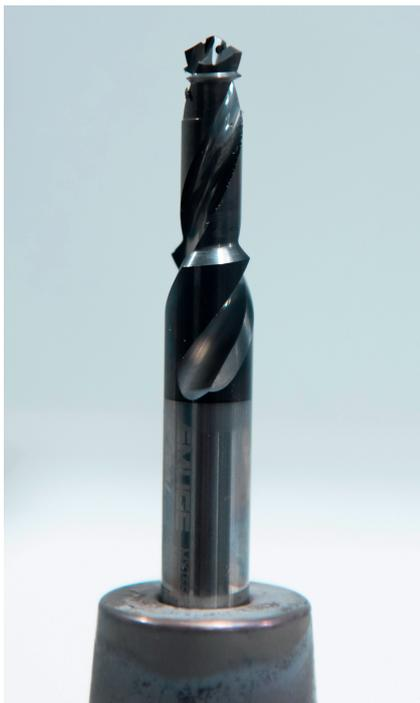
4 Horizont-Erweiterer im Schrumpffutter: der Taptor von Emuge-Franken. Das Werkzeug ist zweischneidiger Spiralbohrer und Gewindebohrer in einem. Nahe der Bohrer-spitze befindet sich ein Gewindefaden
