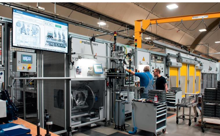
3 Automatisch im 24/7-Betrieb: In der Fertigungslinie (Felsomat) sind drei Horizontal-Bearbeitungszentren Heller 'MC 20' nebeneinander angeordnet, ergänzt durch eine Teilwaschanlage. Ein Gelenkarmroboter fährt auf Schienen die Stationen ab
