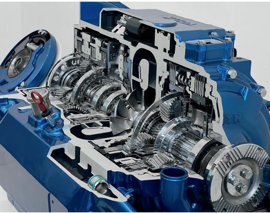
2 Ein Modell des Bus-Automatikgetriebes 'DIWA 6', in dessen aus Aluguss-GD-ALS110-Gehäuse der Taptor Innengewinde einbringt. DIWA steht für Differentialwandler, der beim Bremsen als Retarder arbeitet und so die Betriebsbremse entlastet
